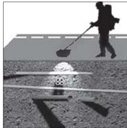
Obr. 1 Lokalizace inženýrských sítí pomocí georadaru
