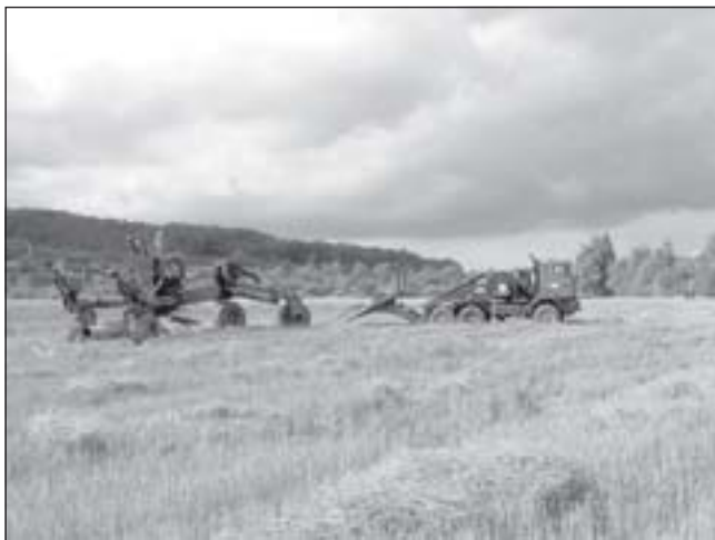
Obrázek 3: Tahač s kladkou a pluhový pokladač
