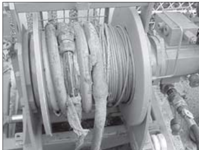
Obr. 5 – Vytažená spojka na bubnu – metoda hydros®LEAD
